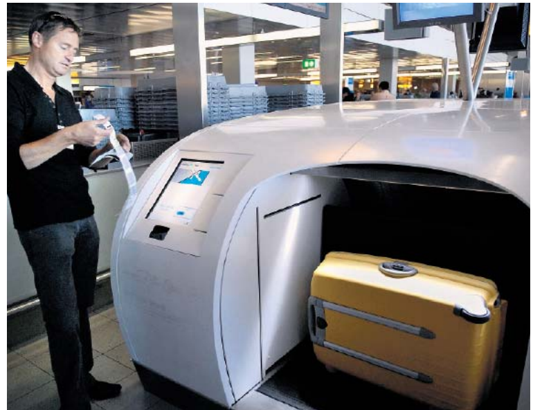
Zelf een koffer inchecken: gegevens intoetsen, instapkaart langs een laser halen, koffer in de machine zetten en een label eraan plakken.
